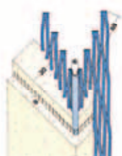
Protector Eckprofile für Wärmedämmputze
